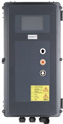
Die CS 320 FU ist eine Komfort-Automatiksteuerung mit Frequenzumrichter. Hierbei wird die Standardplatine CS 320 um einen Frequenzumrichterbaustein erweitert und lässt somit ein drehzahlunabhängiges Steuern von Toren zu. Das sorgt nicht nur für optimale Dynamik, sondern auch für einen energieeffizienten Betrieb der Toranlage. 2 Auslieferungsvarianten stehen zur Verfügung: CS 320 FU-E – der Frequenzumrichter ist im Steuergehäuse integriert
