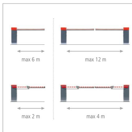
A scelta, con sbarra diritta o pieghevole. Per accessi fino a max 6 m di larghezza, fino a **max 12 m** con la doppia barriera.
