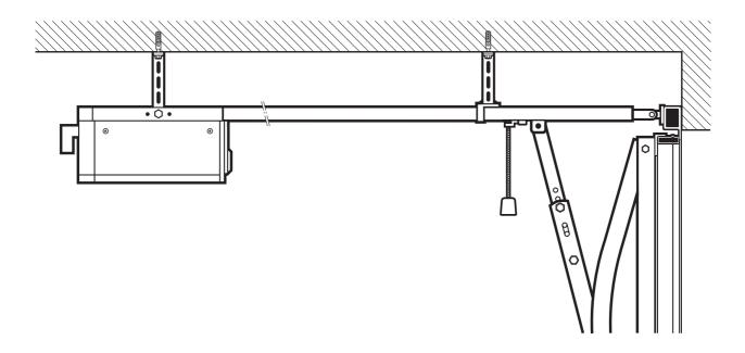
Tor ganz öffnen, Führungsschlitten (F) und Schubstange (G) mit Kurventorarm (C) verbinden (Maßangabe beachten). Durch Absenken der Führungsschiene und durch Auseinanderziehen der Schubstange wird die Toröffnung vergrößert. Die Schubstange darf nur soweit auseinander gezogen werden, daß die innenliegenden Druckrollen (H) nicht an die Begrenzungsschrauben (I) stoßen.
