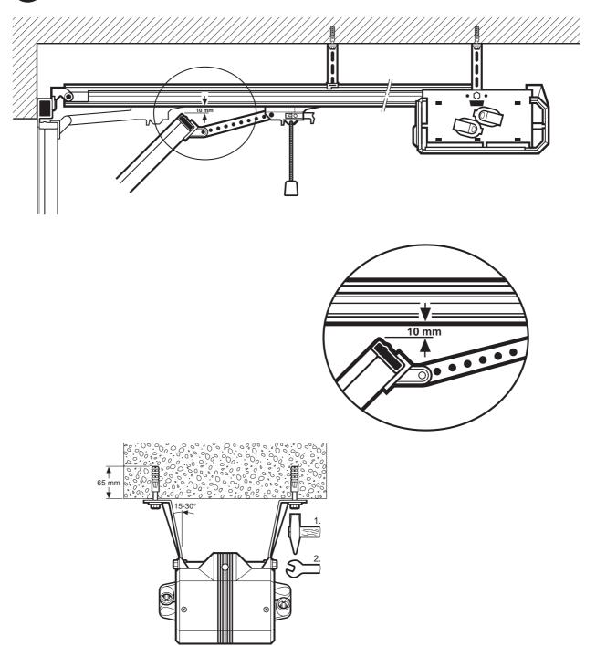
Antriebsgehäuse mit Führungsschiene so abhängen, daß Toroberkante am höchstem Punkt der Öffnungsbahn 10 mm unterhalb der Führungsschienenunterkante liegt (siehe Pkt. 6 und 7). Deckenverankerung nach baulichen Gegebenheiten vornehmen (Maßangabe für Dübelbohrung beachten).
