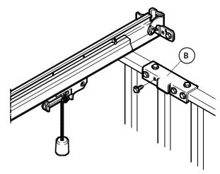
Kurventorarm (C) in Befestigungswinkel (B) stecken und mit zwei Winkelblechen (D) auf Torverstrebung (E) verschrauben. (Bohr ø 5 mm) in der Torverstrebung (4x) (Bohr ø 7 mm) im Kurventorarm (2x) Die Winkelbleche werden mit zwei Schrauben M6 x 10 und Sechskantmuttern mit dem Kurventorarm verschraubt.
