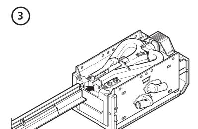
Führungsschiene in das Antriebsgehäuse einschieben.
