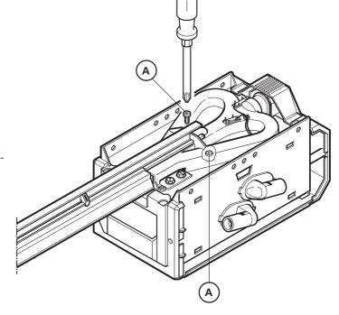
Beiliegende Zentrierschrauben (A) durch Führungsschiene in das Antriebsgehäuse eindrehen.
