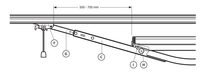
Tor ganz öffnen, Führungsschlitten (F) und Schubstange (G) mit Kurventorarm (C) verbinden (Maßangabe beachten). Durch Absenken der Führungsschiene und durch Auseinander ziehen der Schubstange wird die Toröffnung vergrößert. Die Schubstange darf nur soweit auseinander gezogen werden, daß die innenliegenden Druckrollen (H) nicht an die Begrenzungsschrauben (I) stoßen.
