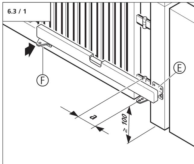
Die vertikale Position des Pfeilerwinkels (E) ist abhängig von der Position des Torwinkels (F).
