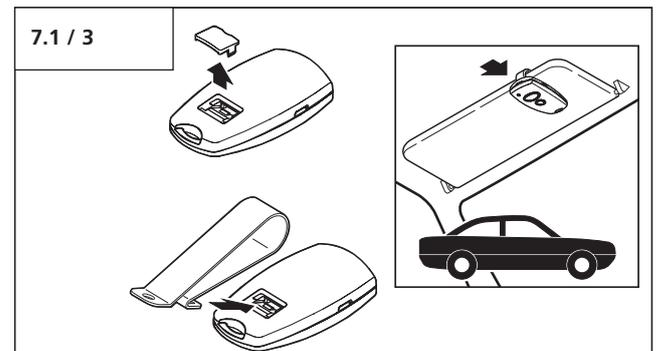
Sonnenblendenclip, geeignet zum Anbringen des Handsenders an eine Sonnenschutzblende im Auto.
