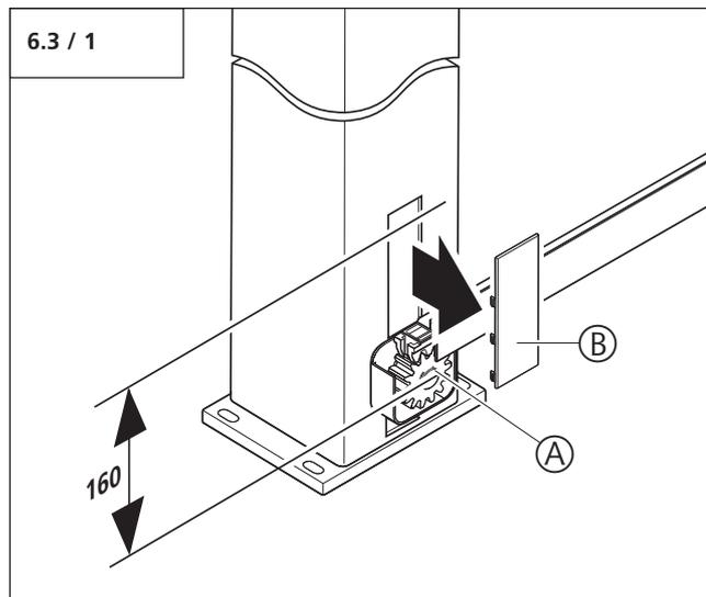
Die Höhe des Stirnrads (A) kann am Motor-Aggregat in einem Bereich von 160 mm eingestellt werden.
