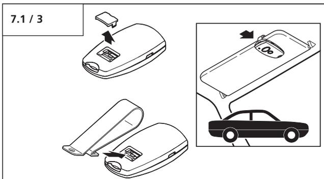
Sonnenblendenclip, geeignet zum Anbringen des Handsenders an eine Sonnenschutzblende im Auto.
