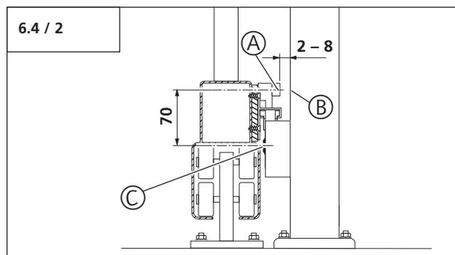
Die Montage des Referenzpunktmagneten ist abhängig von der verwendeten Zahnstange.
