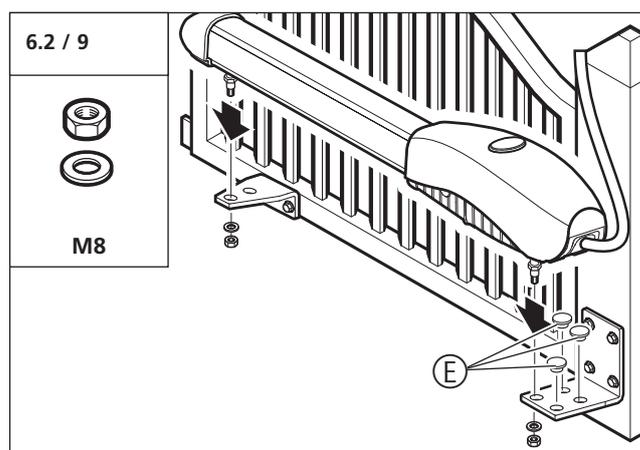
Bei zweiflügeligen Toranlagen muss das Motor-Aggregat mit der kurzen Zuleitung auf der Steuerungsseite montiert werden.
