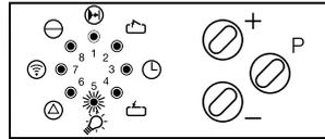
Der Antrieb hat die Möglichkeit des Anschlusses einer externen Signalleuchte, wenn an der Steuerung der Relais-Nachrüstsatz 'Torfunktion AUF-ZU+Licht' für Normantriebe im Gehäuse (Art-Nr: 152137) angeschlossen wird und der automatische Zulauf aktiviert ist. Dieser Ausgang kann so programmiert werden, daß die Signalleuchten blinken oder leuchten.
