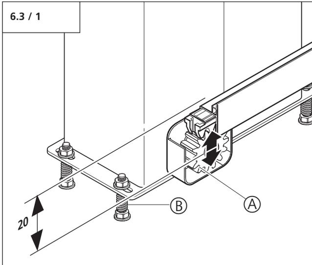
Die Höhe des Stirnrads (A) kann am Motor-Aggregat in einem Bereich von 20 mm eingestellt werden.
