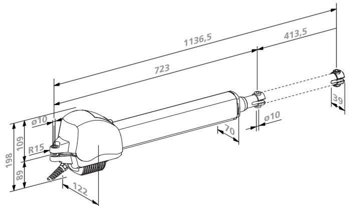
Abmessungen Motor-Aggregat, Ausführung lang
